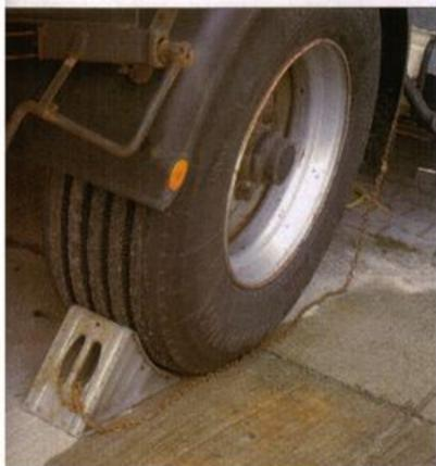
Alle Lkw müssen an der Rampe mit einem Keil gesichert sein.
